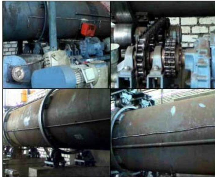
Rotary kiln yang bisa memproduksi karbon aktif 650kg/jam Desain dan produk mesin oleh Girun Alfathoni (Gresik 2003 ) Panjang 16 m, diameter 1,5 m; berat termasuk batu tahan api 120 ton Video demo klik pada foto.
